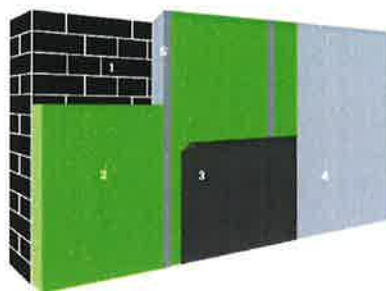
1. Buitengevel | 2. Isolatie | 3. Dampschermb | 4. Binnenafwerking | 5. Stijl- en regelwerk (optioneel)
